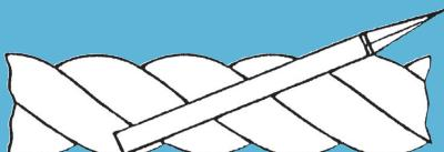
なお、ハツ打ちロープにあっては、スチールテープでロープの周を測った後、次の式によって直径を算出する。
